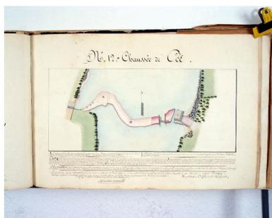
Planche N° 12 du recueil des plans des barrages de la partie navigable de la Mayenne. Plan d'ensemble du site de Cée avant la canalisation de la rivière : barrage, porte marinière, moulin à farine alors en activité, supprimé depuis (rive droite, à Origné) et moulin à farine alors détruit, reconstruit ensuite, actuellement en ruine (rive gauche, à Villiers-Charlemagne).
