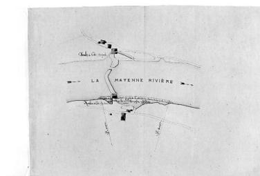
Plan d'ensemble du site de Cée et des aménagements prévus pour la canalisation de la rivière : barrage et moulin de la rive droite à Origné (détruits), moulin de la rive gauche à Villiers-Charlemagne (abandonné à la ruine), chemin de halage (réalisé).
