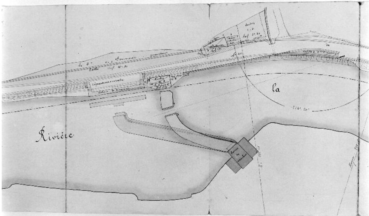
Plan d'ensemble du site : l'ancien barrage et le moulin de Cumont (détruits), la maison éclésiastique, l'écluse et le nouveau barrage (réalisés selon ces dispositions), la scierie de marbre (conservée).
