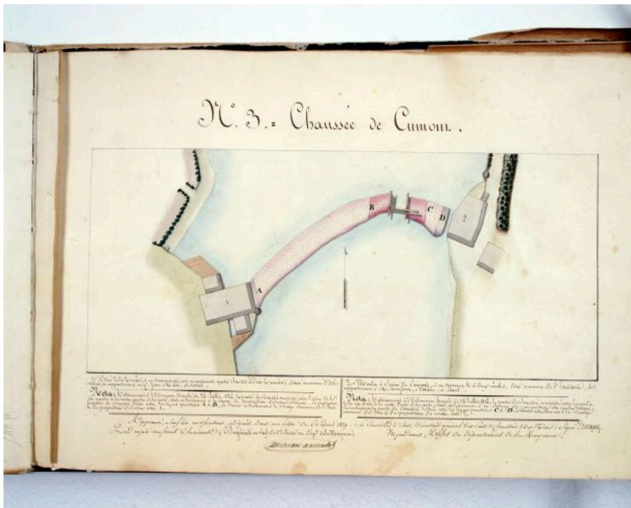
Planche N° 3 du recueil des plans des barrages de la partie navigable de la Mayenne. Plan d'ensemble du barrage de Cumont avant la construction de de l'écluse : barrage, porte marinière, moulin à farine, usine à scier le marbre.
