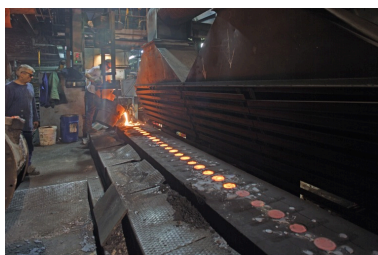
Le poste de moulage : remplissage des moules. Phot. François Lasa IVR52_20065300118NUCA
