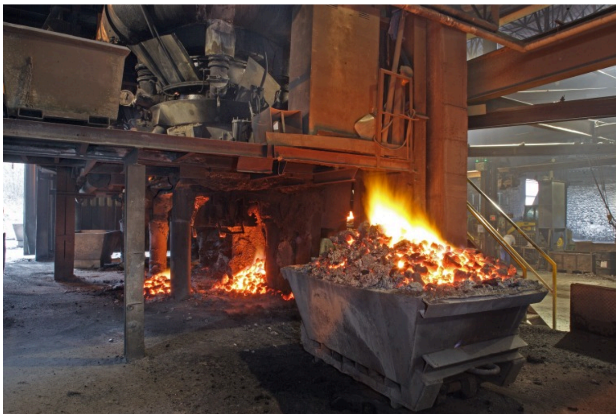
La récupération du laitier à la base des cubilots.
