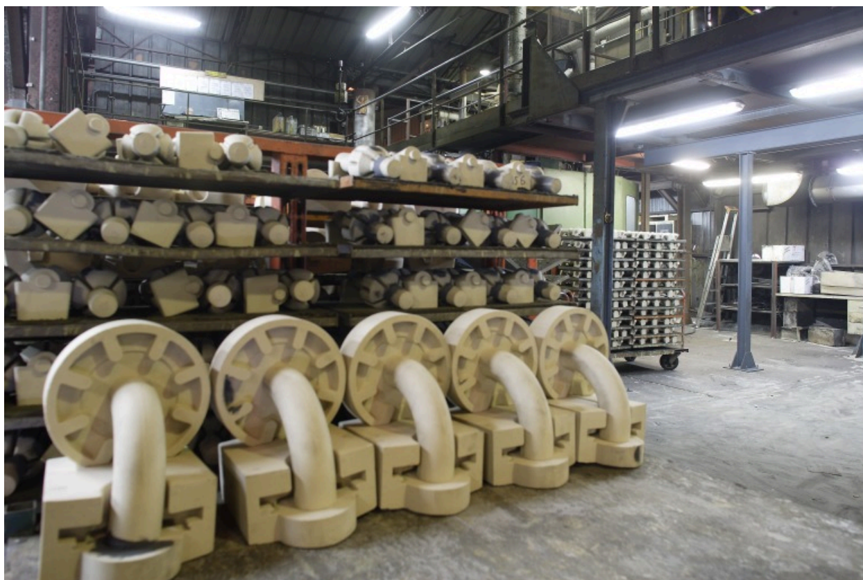
L'entrepôt des modèles, situé entre la halle de fonderie et la halle de finition.
