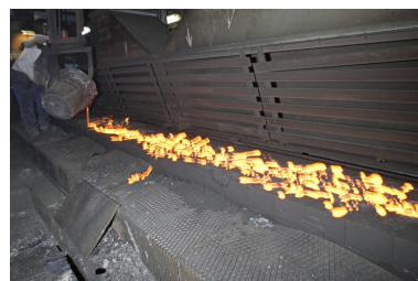
Le poste de moulage : remplissage des moules. Phot. François Lasa IVR52_20065300120NUCA
