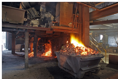
La récupération du laitier à la base des cubilots. Phot. François Lasa IVR52_20065300108NUCA
