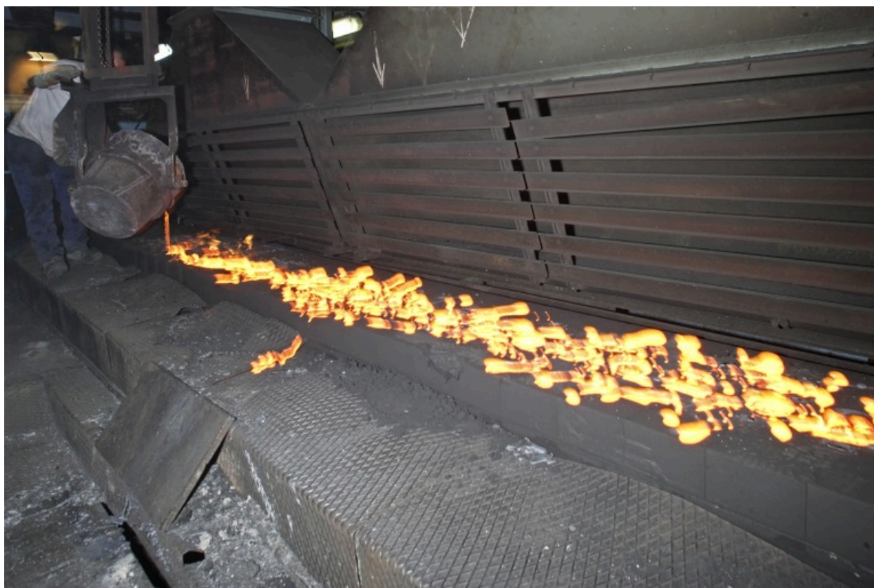
Le poste de moulage : remplissage des moules.
