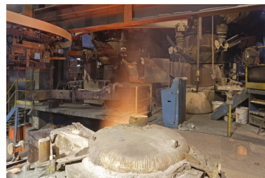
La partie inférieure des cubilots vue depuis l'atelier de coulée. Phot. François Lasa IVR52_20065300113NUCA
