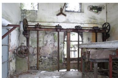
Le moulin à farine, rez-de-chaussée, pièce est : vannes d'amont du coursier de la turbine.
