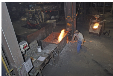
L'élimination des scories provenant de la poche de coulée. Phot. François Lasa IVR52_20065300115NUCA
