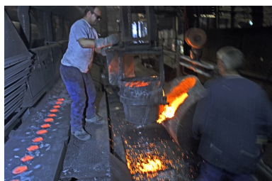
Le poste de moulage : versement de la fonte d'une poche de coulée dans un godet. Phot. François Lasa IVR52_20065300119NUCA
