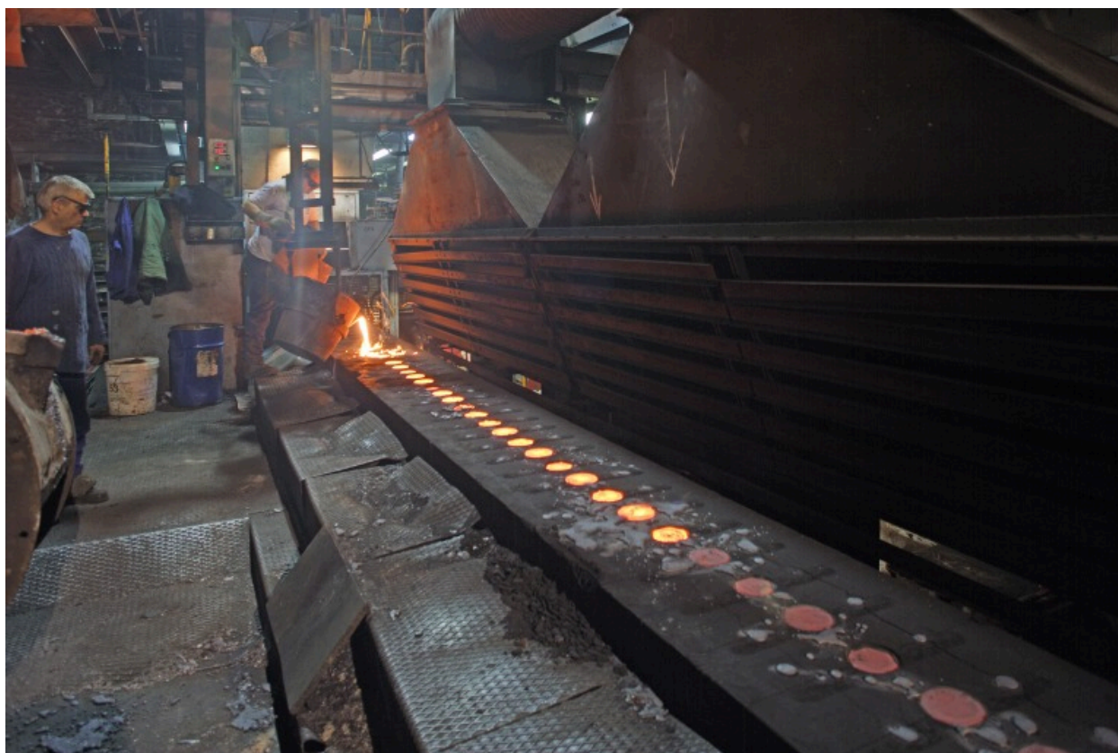
Le poste de moulage : remplissage des moules.
