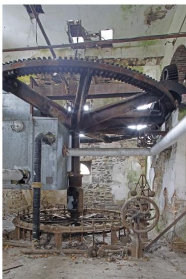
Le moulin à farine, rez-de-chaussée. La pièce est vue depuis le nord : les roues et le pignon de transmission de la force motrice et le régulateur de vitesse de la turbine.
