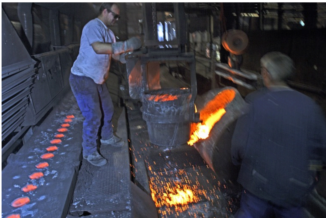
Le poste de moulage : versement de la fonte d'une poche de coulée dans un godet.
