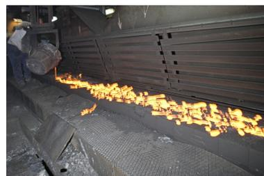
Le poste de moulage : remplissage des moules.
