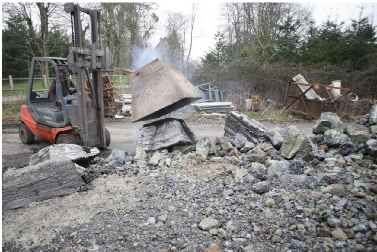
Le transport et le dépôt du laitier.
