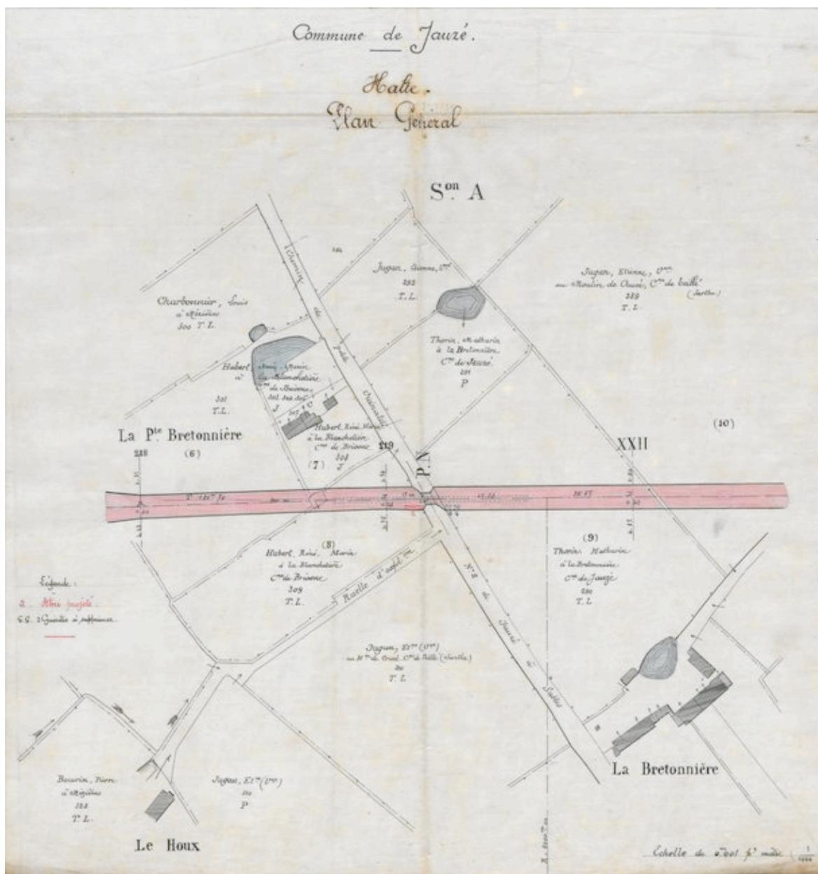
Projet d'implantation de la halte en 1897. En rose : tracé de la voie ferré, avec l'emplacement de la halte à construire à gauche de la route. Les guérites existantes sont figurés à droite de la route.
