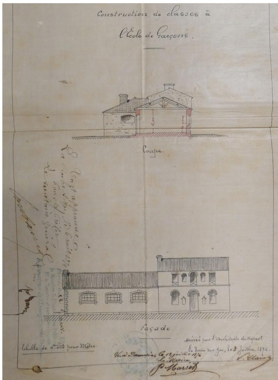
Projet d'agrandissement par Victor Clair, 3 juillet 1874 : élévation ouest et coupe de la salle de classe proposée au nord du logement.
