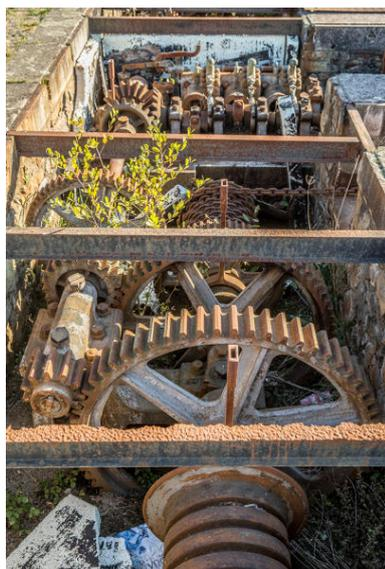
Vue de détail du mécanisme d'actionnement des portes de l'écluse.
