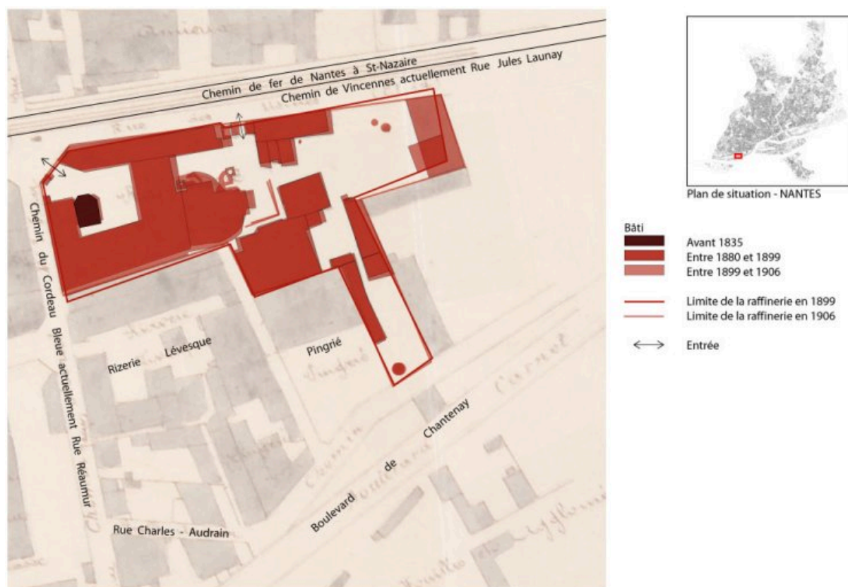
Evolution du plan de masse de la raffinerie entre 1899 et 1906. Fond : plan de 1906.
