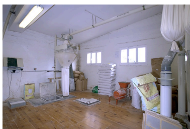
Corps de bâtiment jouxtant la minoterie, comble : l'ancien mélangeur. Phot. François Lasa IVR52_20075300797NUCA
