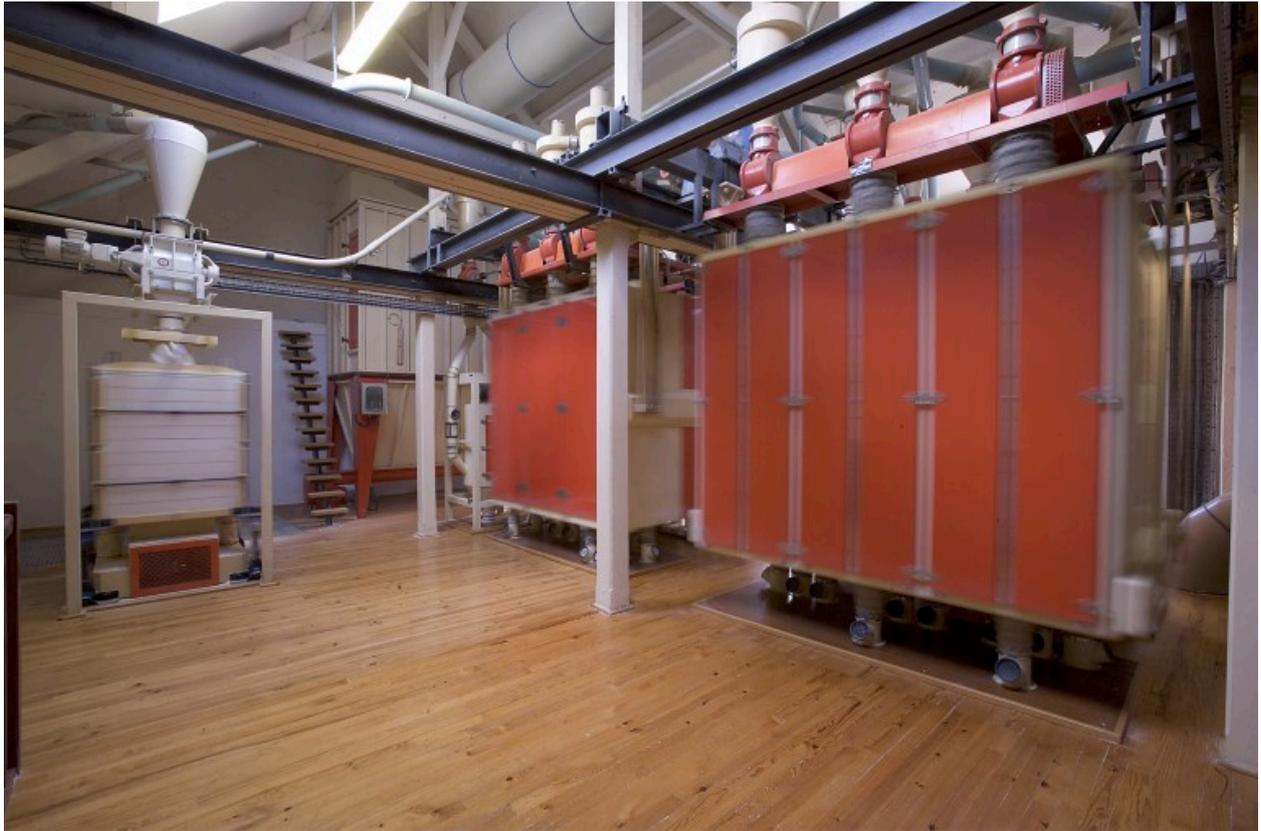
Minoterie, comble. De gauche à droite : le plansichter de sûreté, le filtre à air et les plansichters Sangati.
