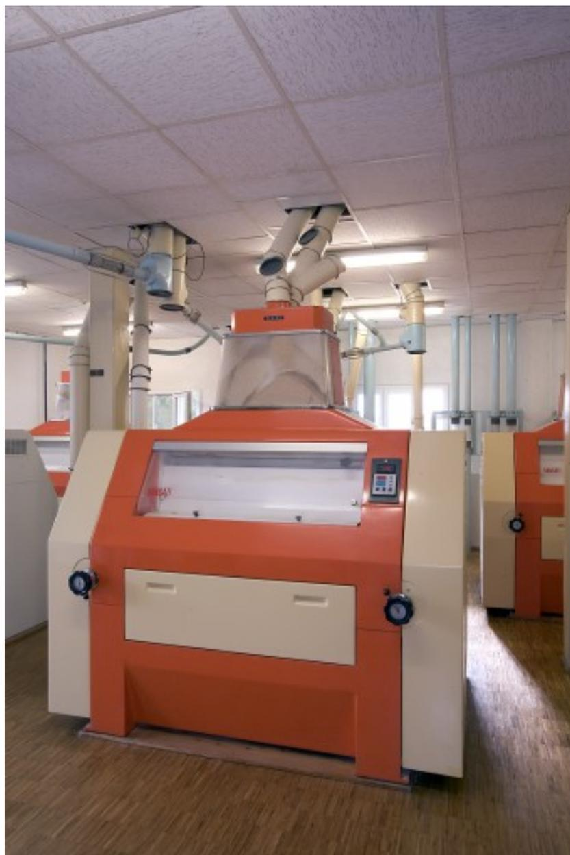
Minoterie, rez-de-chaussée : broyeur à cylindres Sangati.
