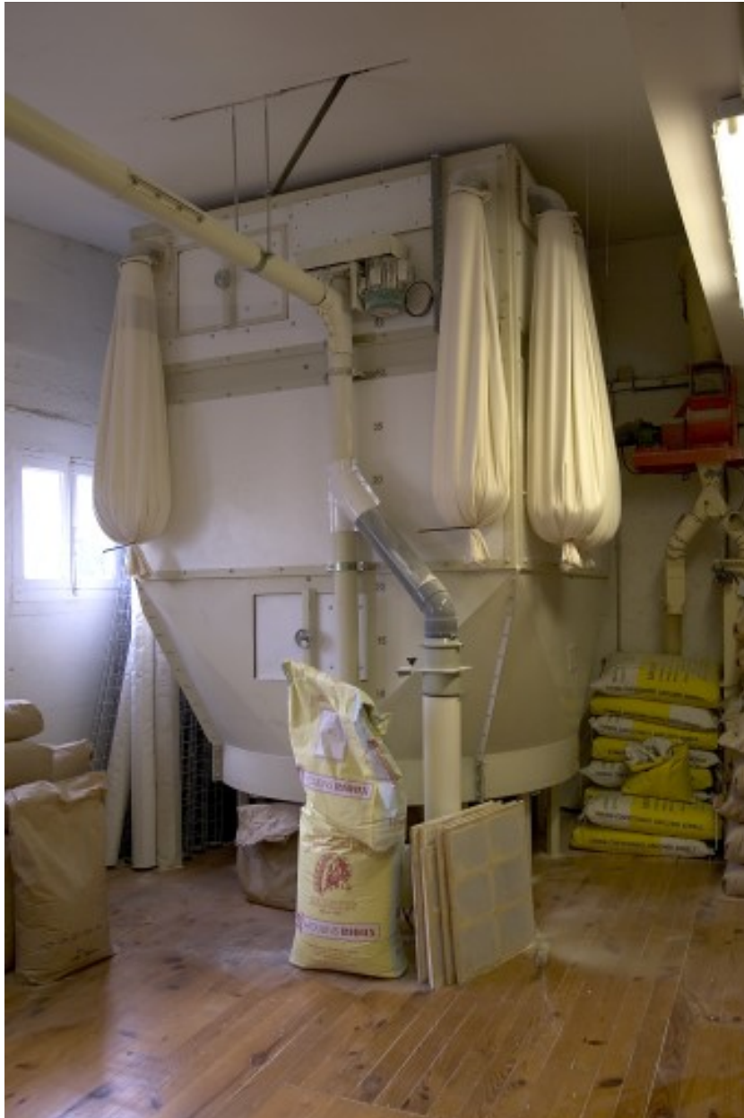
Corps de bâtiment jouxtant la minoterie, comble : le silo de mélange de base pour les farines spécifiques.
