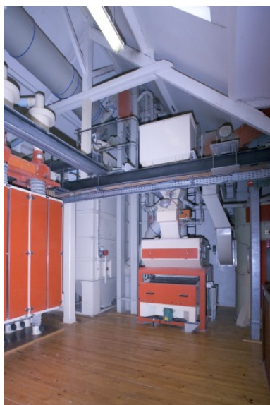
Minoterie, comble : le nettoyeur à blé. Phot. François Lasa IVR52_20075300795NUCA
