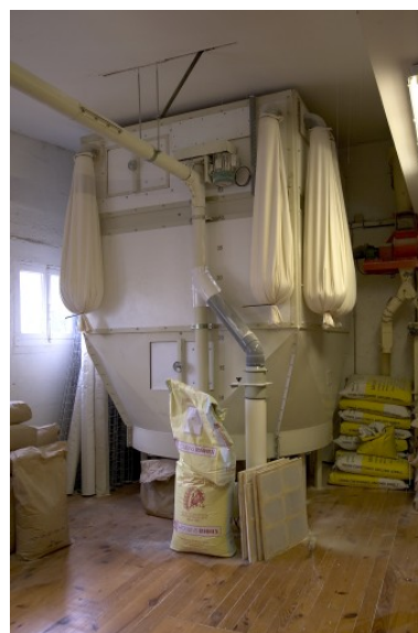
Corps de bâtiment jouxtant la minoterie, comble : le silo de mélange de base pour les farines spécifiques. Phot. François Lasa IVR52_20075300796NUCA
