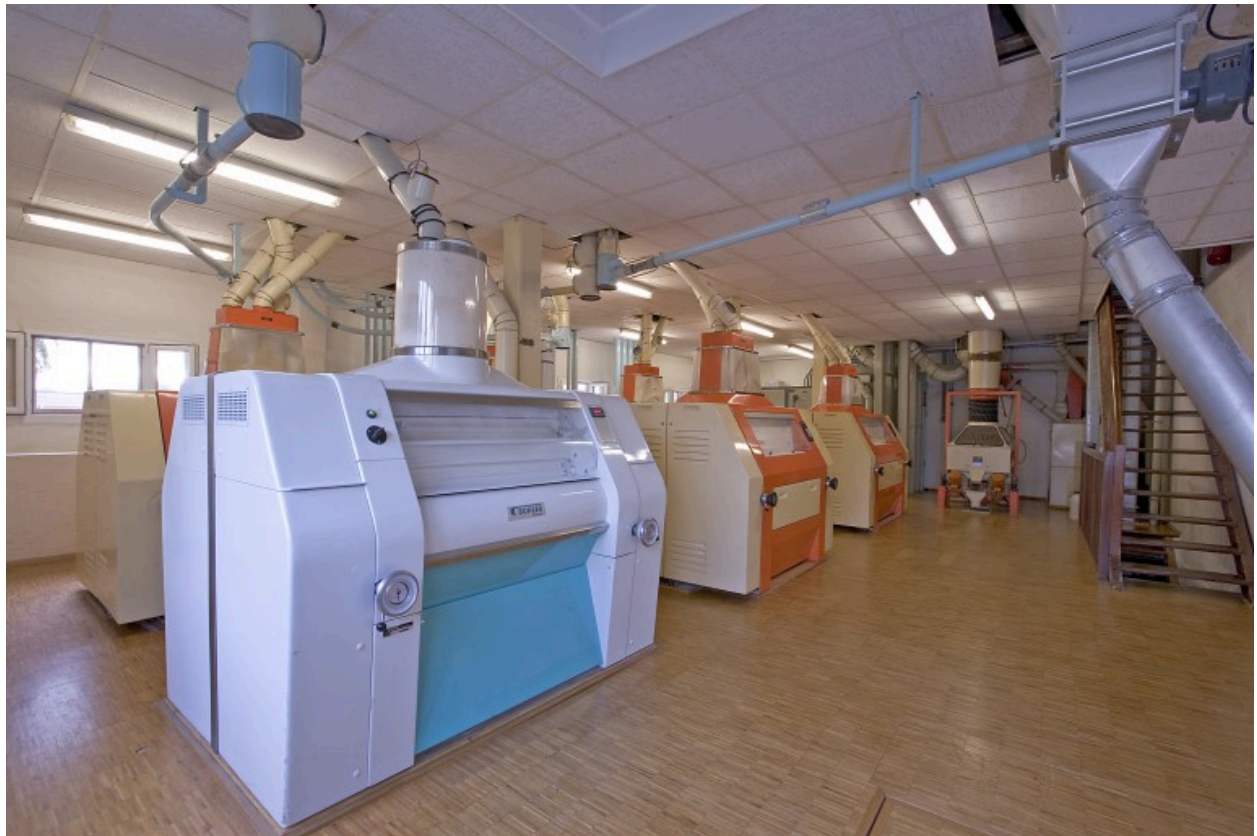
Minoterie, rez-de-chaussée : le broyeur à cylindres Bühler et les broyeurs Sangati. Au fond l'épierreur.
