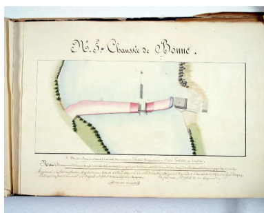
Planche N° 5 du recueil des plans des barrages de la partie navigable de la Mayenne. Plan d'ensemble du site de Bonne avant la construction de l'écluse : barrage, porte marinière, moulin à farine, situé rive droite à L'Huisserie. Autr. Louis-Xavier Deslandes de Lancelot, Repro. François Lasa IVR52_20015300162XA
