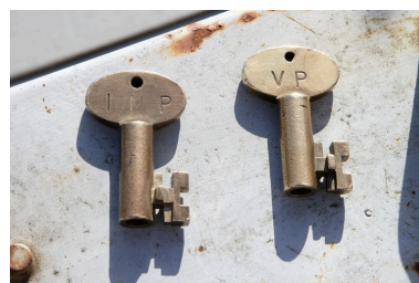
Clés permettant d'actionner le levier de manœuvre. Phot. Denis Pillet IVR52_20104402511NUCA
