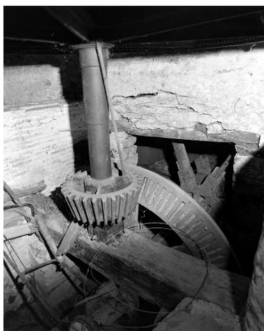
Détail de la transmission du vieux moulin : l'arbre moteur (relié à la roue hydraulique située à l'ouest de l'autre côté du mur), le rouet de fosse, l'axe vertical et son pignon.
