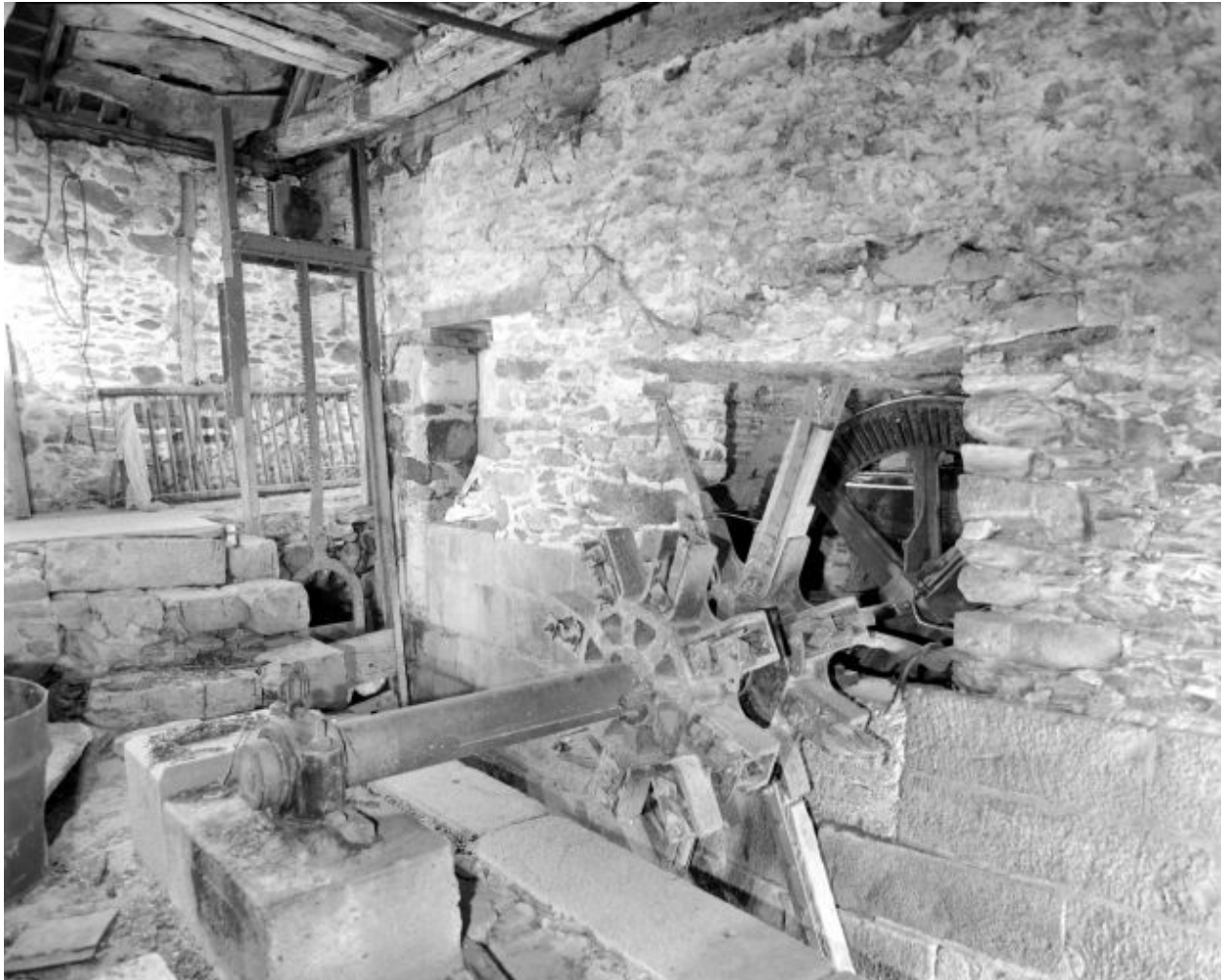
Rez-de-chaussée du vieux moulin, partie ouest : les vestiges de la roue, l'arbre moteur et la vanne d'amont du coursier vus du sud-ouest.
