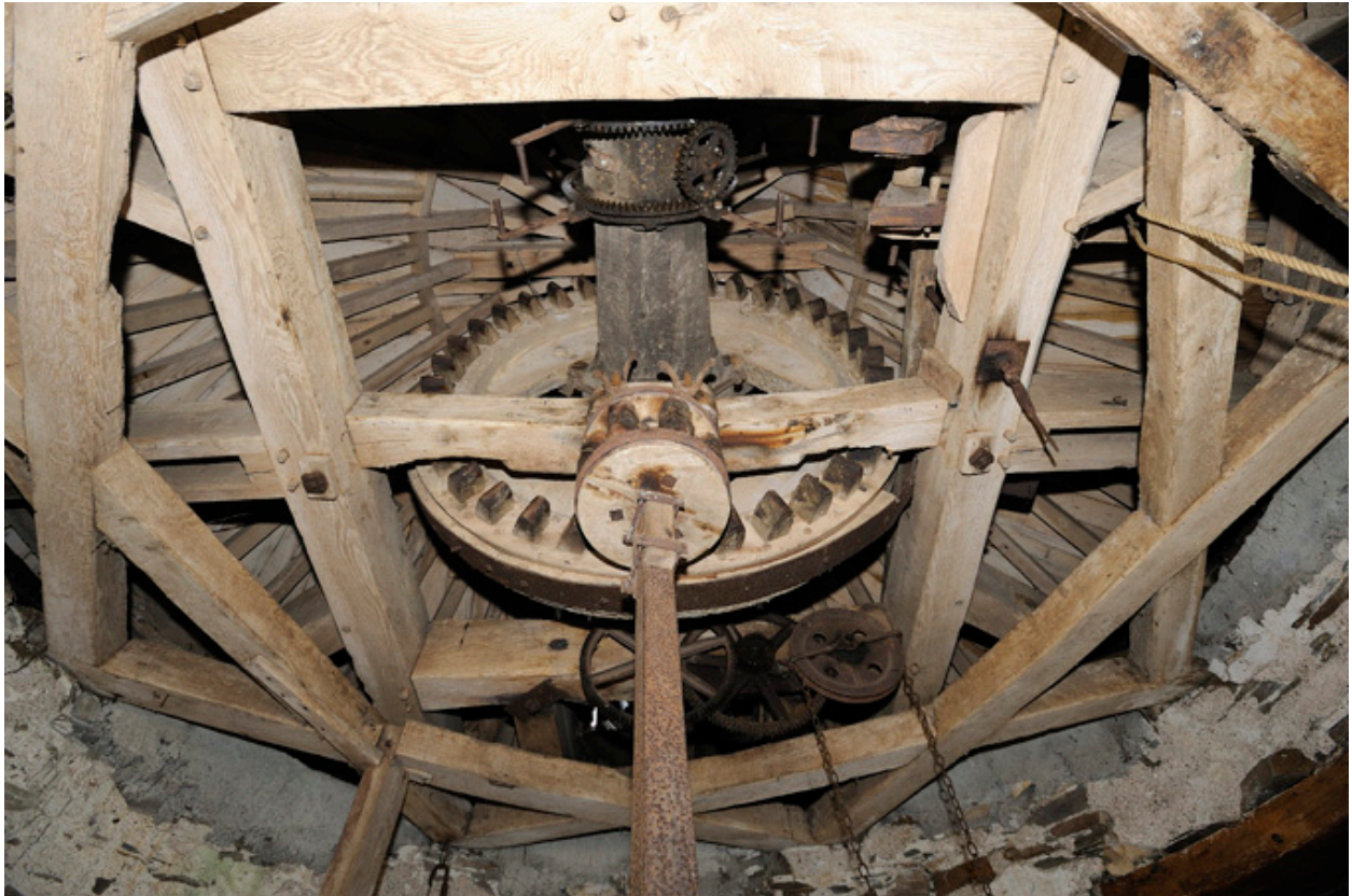
Mécanisme composé de l'arbre moteur, du grand rouet, de la lanterne et du gros fer, permettant d'actionner la meule.
