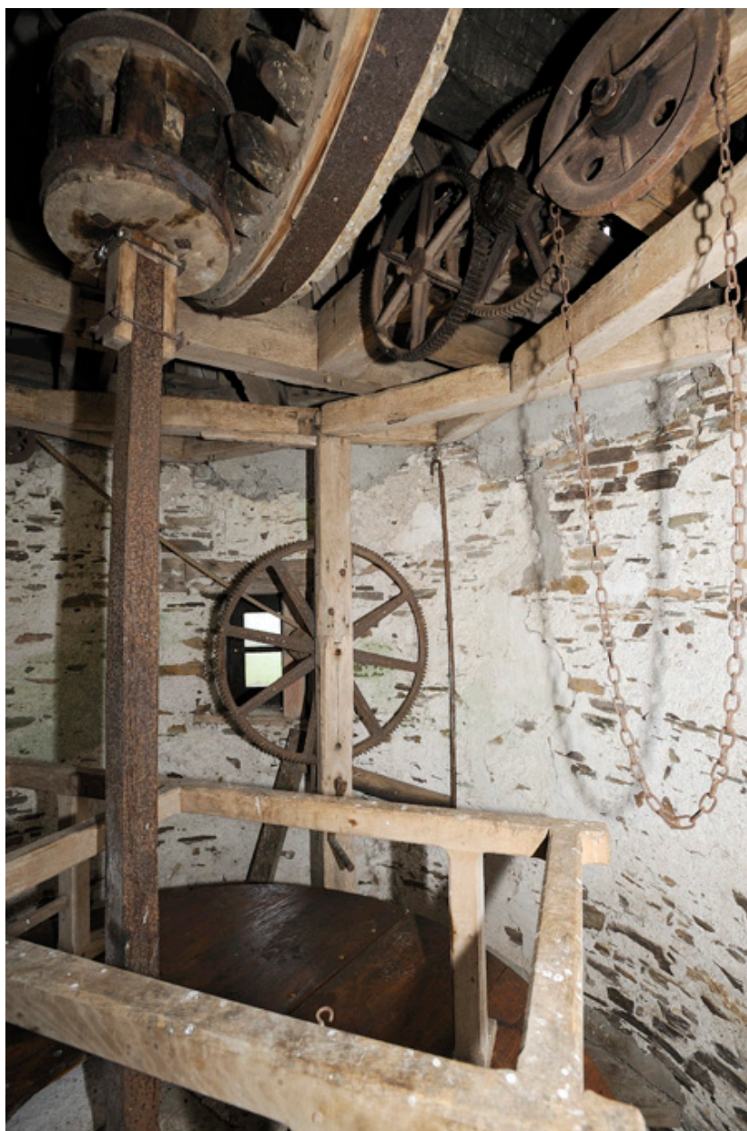
Mécanisme composé de l'arbre moteur, du grand rouet, de la lanterne, du gros fer et de la paire de meules.
