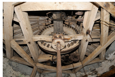
Mécanisme composé de l'arbre moteur, du grand rouet, de la lanterne et du gros fer, permettant d'actionner la meule. Phot. Bruno Rousseau IVR52_20114900281NUCA
