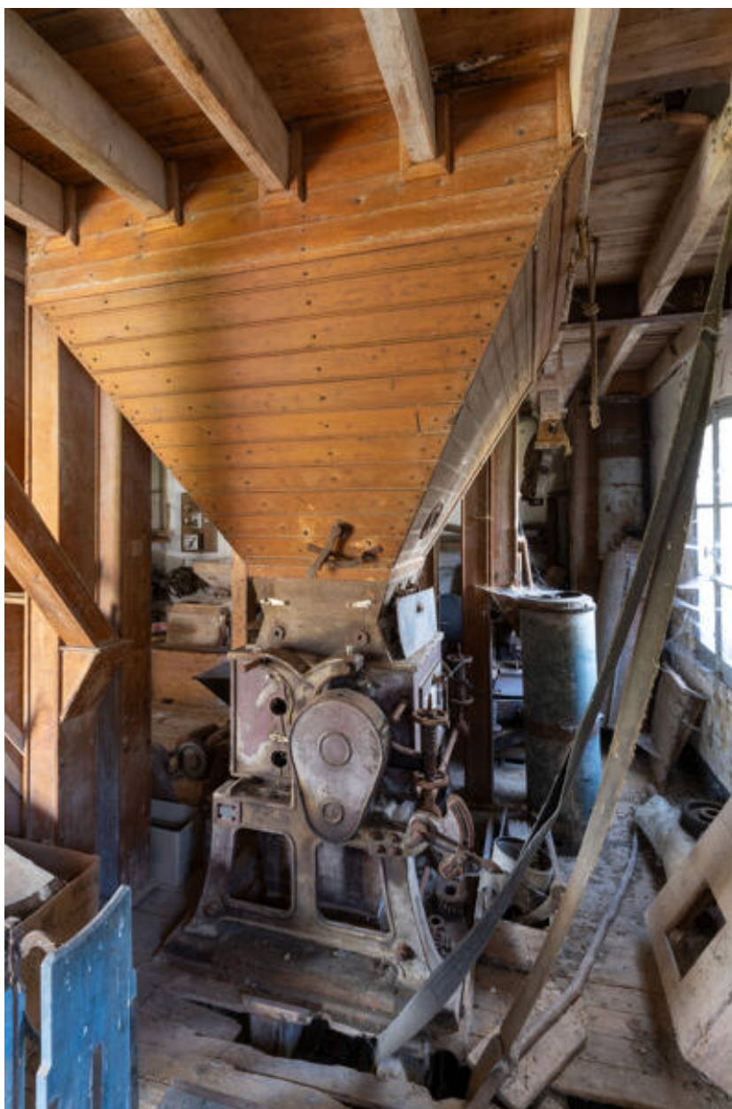
Machines du moulin, premier étage : broyeur.
