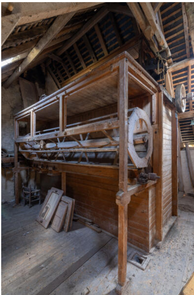
Machines du moulin, comble : bluterie à boulange.
