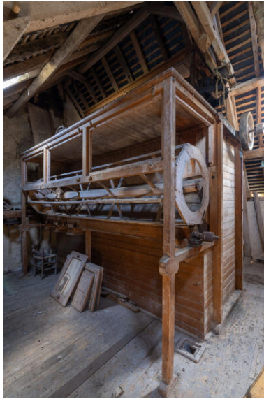
Machines du moulin, comble : bluterie à boulange. Phot. Jeanne Minier IVR52_20257200683NUCA
