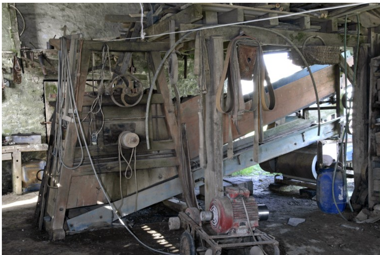
Vue postérieure d'ensemble : à gauche, la batteuse ; à droite, le secoue-paille et le tapis roulant à grains ; au premier plan, le moteur électrique.
