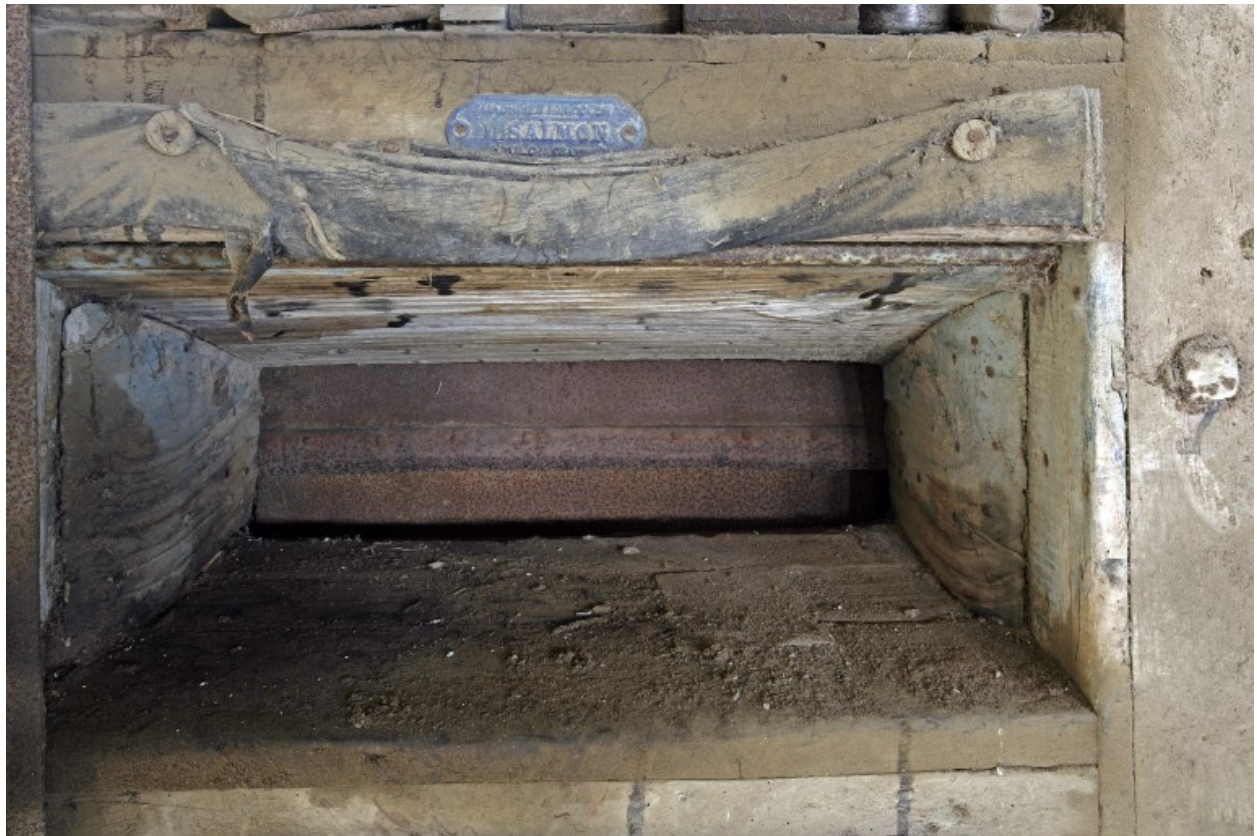
L'ouverture latérale de la batteuse par laquelle étaient entrées les gerbes.
