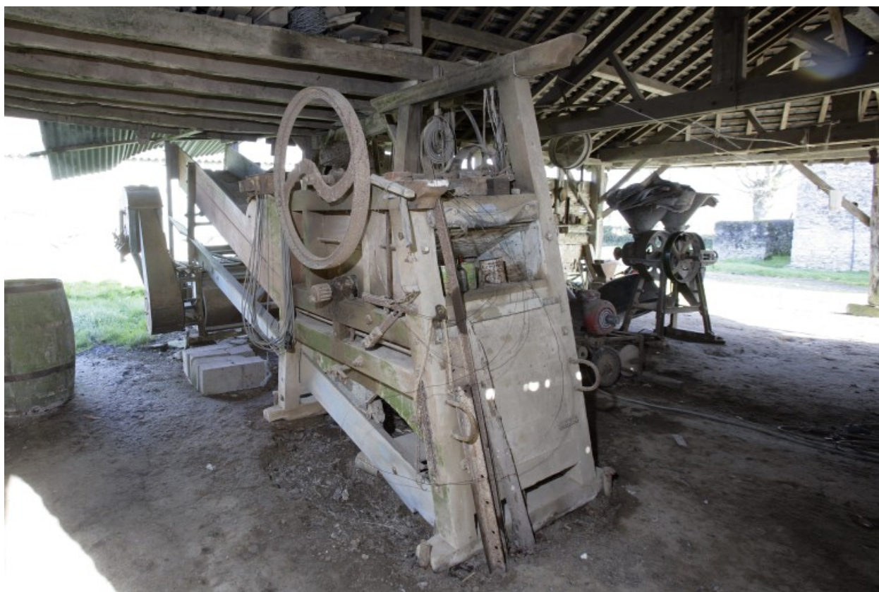
Vue antérieure droite : au premier plan, la batteuse ; au second, le secoue-paille, le tapis roulant à grains et la vannette.
