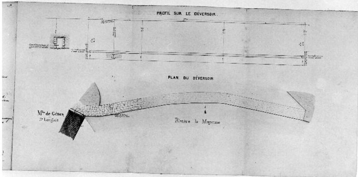
Plan-masse du barrage et d'une partie du moulin et profil du barrage, 1866.
