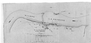
Plan d'ensemble du site de Gaudrée et des aménagements projetés en vue de la canalisation de la Mayenne : barrage (détruit), moulin (détruit) et ses dépendances, chemin de halage (réalisé).
