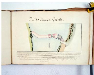
Planche N° 14 du recueil des plans des barrages de la partie navigable de la Mayenne. Plan d'ensemble du site de Gaudrée avant la canalisation : barrage, porte marinière, moulin à farine (détruit).
