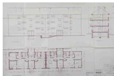
Plan du rez-de-chaussée, élévation de la façade nord et coupe des bâtiments G et H, 1954.
